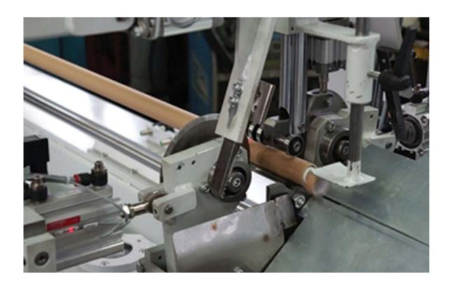
Macchina automatica per il taglio di tubi di cartone da 26 a 100 mm. di diametro e Spessore da 3 a 8 mm.
